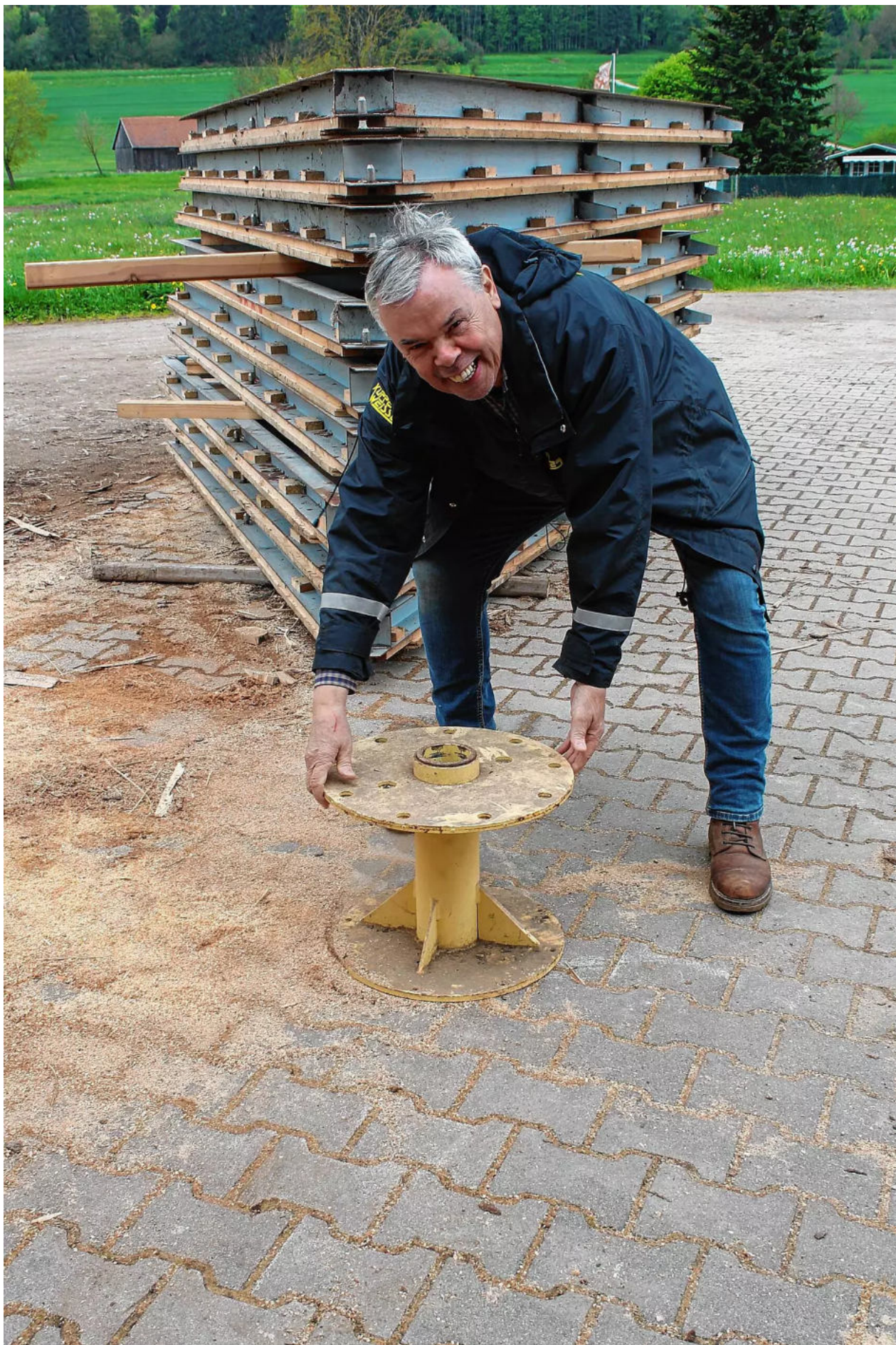
Konstrukteur Paul Rosenstiel 2023 mit dem Drehlager und den zur Verladung bereiten Bühnensegmenten. | Bild: Lutz Rademacher
